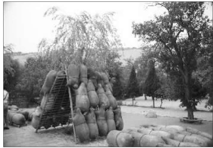
由14个圆筒羊皮做成的羊皮筏子是黄河独有的漂流工具
