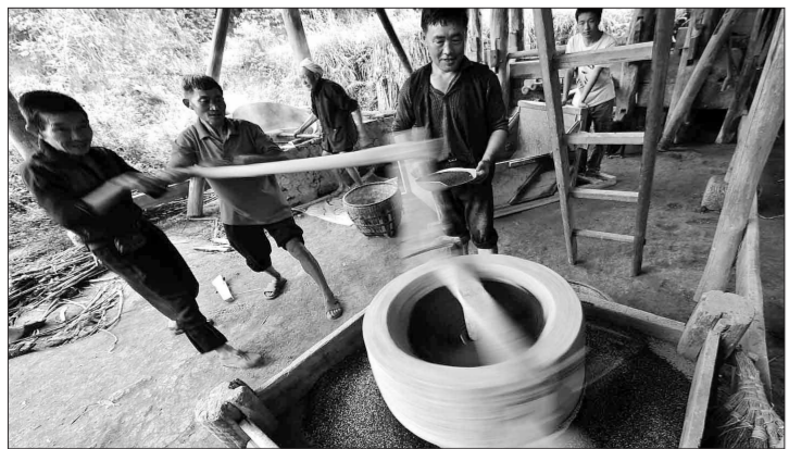
位于湖北省宣恩县李家河乡箭竹坪的一座土家油榨坊,是宣恩县境内仅存的、也是仅用于“表演性”榨油的油榨坊。因其榨油工序繁琐,加之出油率机械榨油要低很多,这种在上世纪六七十年代还十分红火的上法榨油作坊,迅速淡出人们的生活。图为村民用石磨将油籽碾破。(新华社发)
