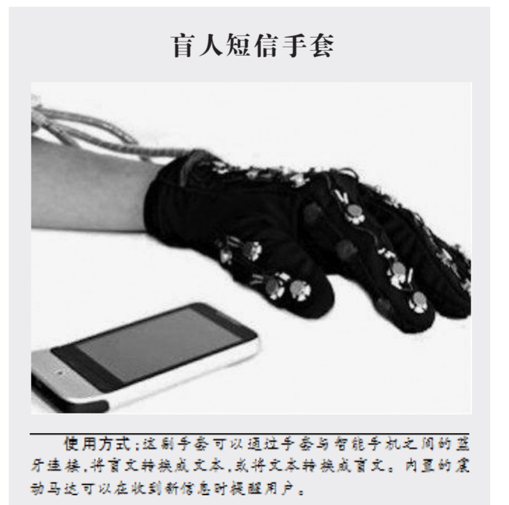
使用方式:这副手套可以通过手套与智能手机之间的蓝牙连接,将盲文转换成文本,或将文本转换成盲文;内置的震动马达可以在收到新信息时提醒用户。
