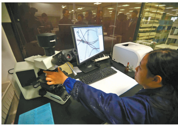
◀ 国图文献修复组工作人员正在进行“纸张纤维测试”。先进的技术手段为修复工作保驾护航,力求最大限度还原古籍原貌,修旧如旧。
